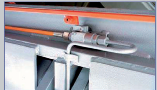
Hydraulisches Sicherheitsventil unter der Hubtischplattform
